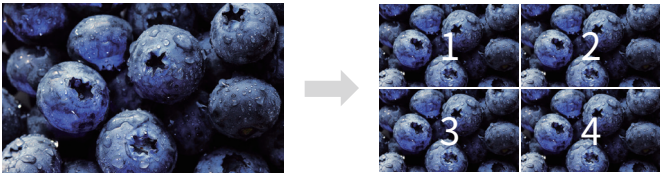
4K/8K 2 Sample Interleave (2SI) 模式: 基于像素进行分割
